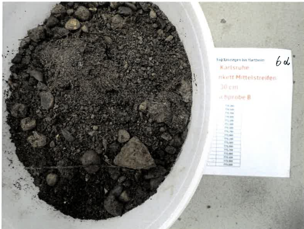
Bild 24: Mischprobe 6d, FR Karlsruhe (West), km 770,300 - km 773,300, Mischprobe B , 15 - 30 cm
